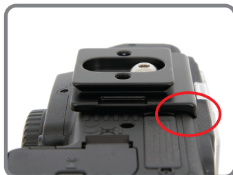
③ プレートのフランジがボディと密着しているか確認後、強く締める
