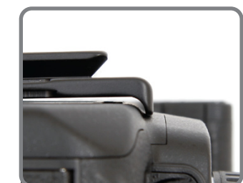
① 上のようにプレートのフランジがボディと密着していない場合、ボディに傷を与える可能性がある。
