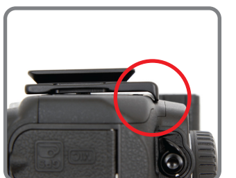
① 上のようにプレートのフランジがボディと密着していない場合、ボディに傷を与える可能性がある。
